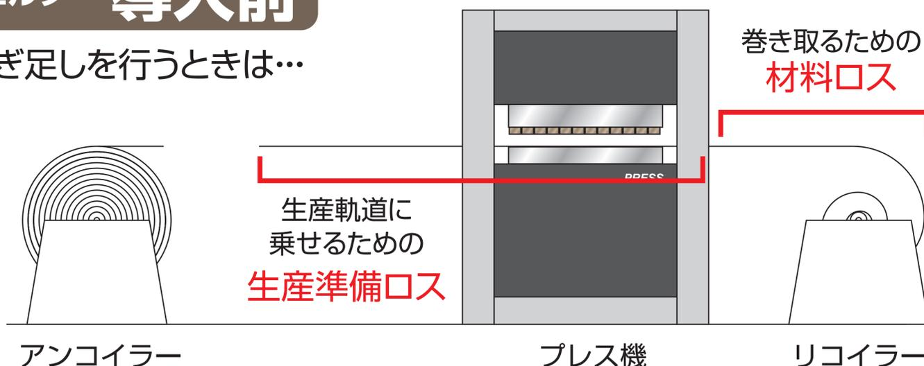
生産準備ロス10Mと巻き取るための材料ロス3M=13Mのロスが必要
